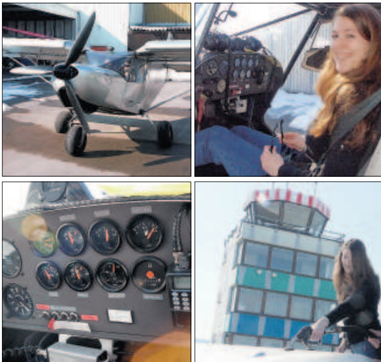
Neben vielen anderen Parametern kann man Höhe, Steigen und Geschwindigkeit ablesen. Ein UL-Flugzeug verbraucht pro Stunde rund 15 Liter bleifreies Benzin.
